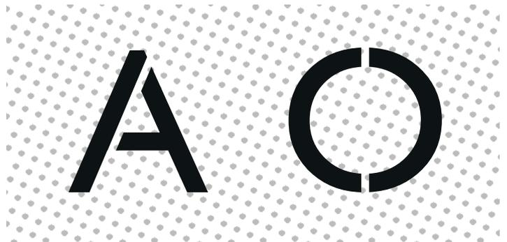
Umso dicker der Steg, desto stabiler die Verbindung der Innen- und Außenteile. Die Dicke der Stege ist abhängig von der Größe des Motivs.
